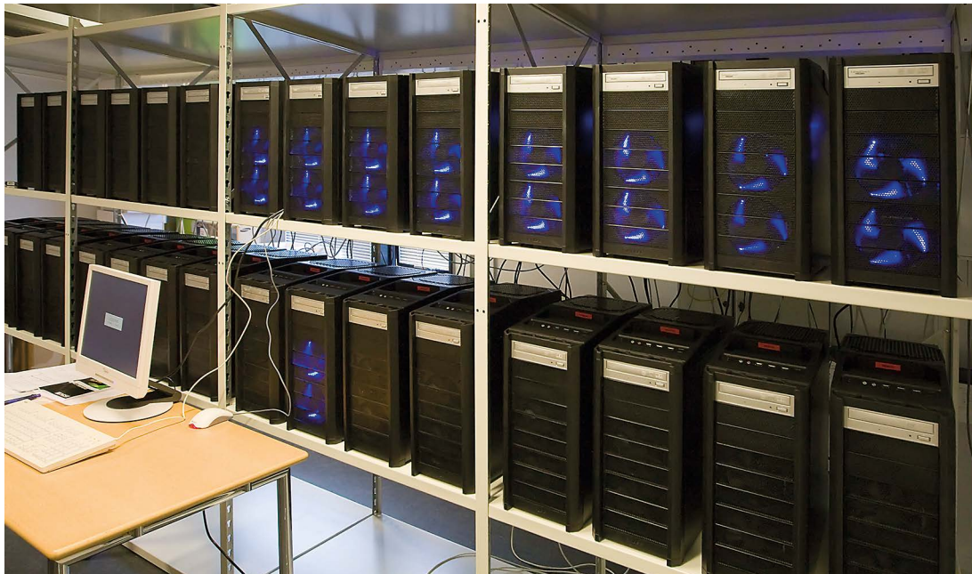
Glas og Tid centrets computere, som siden 2008 primært har været baseret på grafikkort. Disse såkaldte GPU-kort regner meget hurtigt, men har den udfordring at de er svære at programmere optimalt, fordi der kræves særlige instruktioner for at udnytte den enorme regnekraft (se http://rumd.org ). I dag råder Glas og Tid over en regnekapacitet på godt 1000 TeraFlop. Foto: RUC
